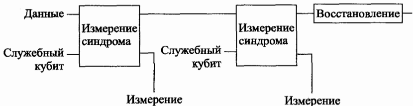
Рис. 5. Четвертый закон. Для обеспечения точности необходимо повторять операции, в частности, измерение синдрома
