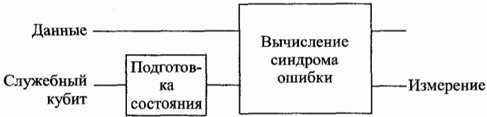
Рис. 3. Второй закон. Служебный кубит должен быть подходящим образом приготовлен
